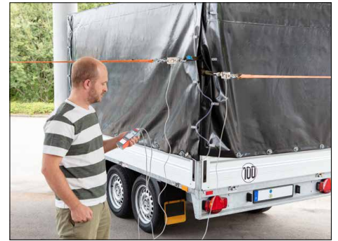
Mesure des forces dans différentes directions de traction ou de compression, possible avec un seul appareil de mesure
