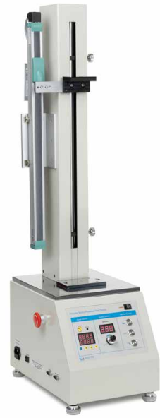
Banc d'essai motorisé incl. appareil de mesure de longueur LD
